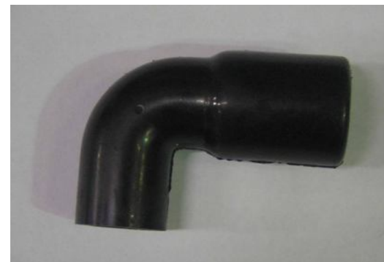
Шланг вентиляции картера дет. 40904.1014075
