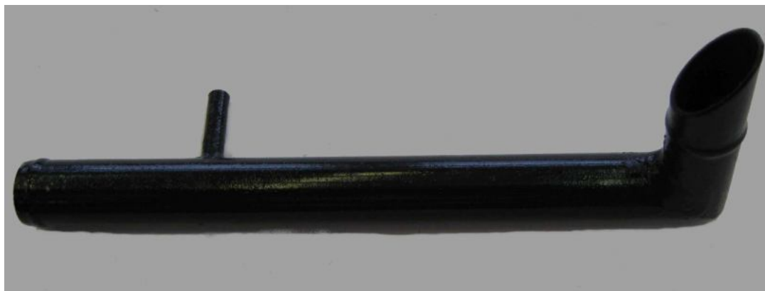
Шланг вентиляции картера дет. 40624.1014075
